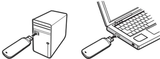
3. Das Betriebssystem erkennt automatisch den Surf-Stick und startet selbstständig den Installationsassistenten. Dieser Vorgang kann einige Minuten in Anspruch nehmen. Befolgen Sie bitte die Anweisungen.
